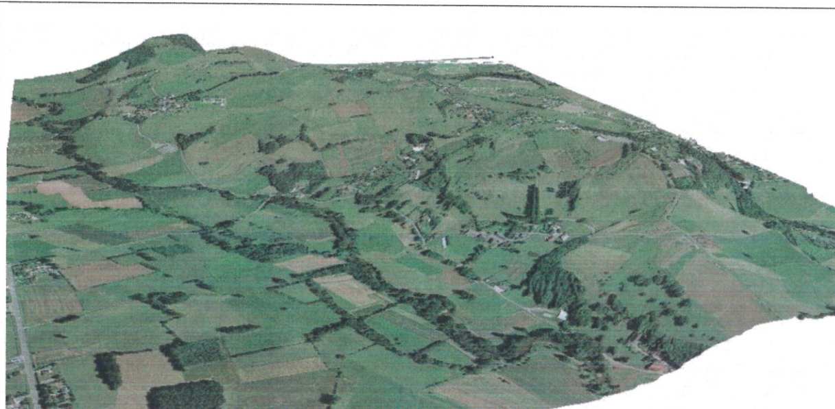
Figure n°3 : Drapage de l'orthophotographie sur le MNT (échelle des hauteurs multipliée par 2).
